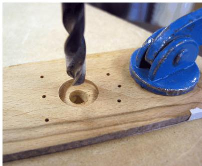
Upotuksen porauksen jälkeen suurennetaan upotuksen reikä **7mm** poralla. Reiästä tulee katkaisijan nuppi läpi.
