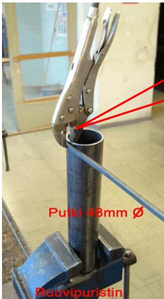
3.1 Kiinnitä teräsputki tukevasti ruuvipuristimeen kiinni ja laita lukkopihtien kanssa tanko lujasti kiinni putken yläpähän.
